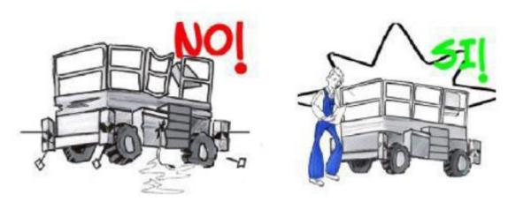
Los estabilizadores deben encontrase en buen estado y funcionar correctamente así como disponer de protección lateral en todo el perímetro de la plataforma, especialmente en la puerta de acceso.
